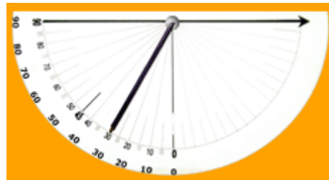
Figuur 10 : Voorbeeld van een optisch instrument dat wordt gebruikt om obstakels (schaduwbronnen) te visualiseren
